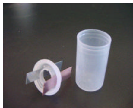
写真1 開発したボルタ電池
