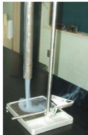
写真3 パイプから吹き出した下降気流
