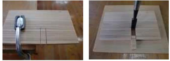
写真5 C型クランプで固定 写真6 追入れのみで切断
