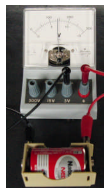
写真4 電池Bの端子電圧
