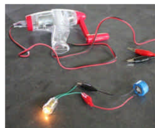
写真1 コンデンサーによる豆電球の点灯実験
