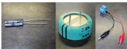
写真2 リード形電解コンデンサー
