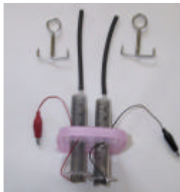
写真4 電解槽のふた
