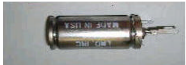
図4 GM管(直径15mm,長さ40mm)
