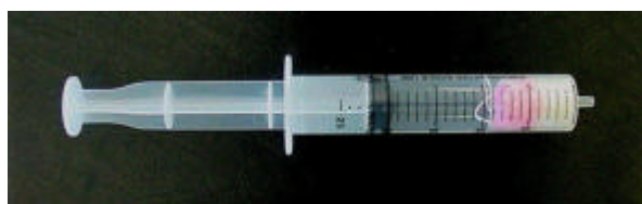
図 7 マントル入り注射器
