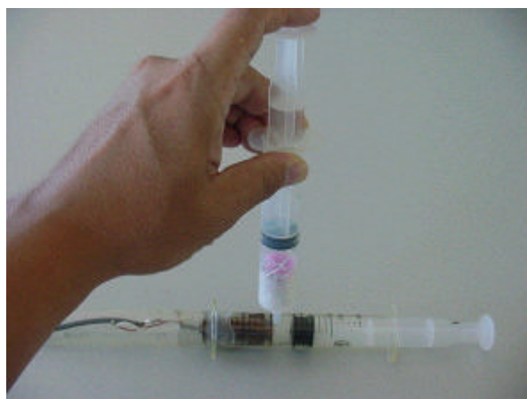
図 8 GM 管付き注射器に ^{220}\text{Rn} を 10mL 注入
