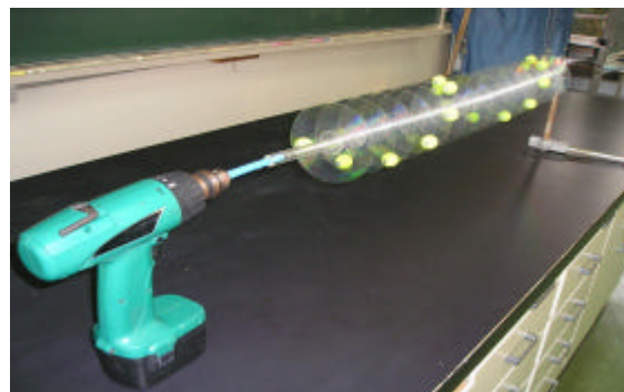
写真8 完成した正弦波位相説明器
