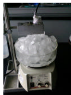
写真1 平底フラスコを氷で冷やしている様子
