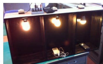
写真5 白熱電球、蛍光灯、LED電球の比較実験装置
