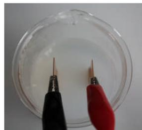
写真1 固まった電解液と銅極板
