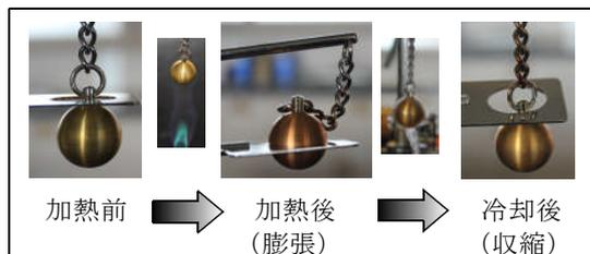
図1 金属球膨張試験器を用いた実験
