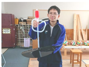
写真25 水たまり排水用ポンプ
