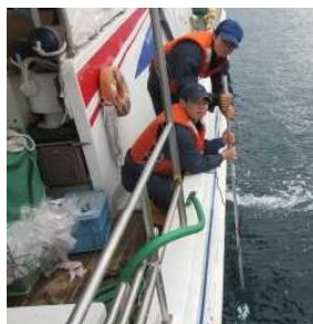
写真6 振動子の海中投入
