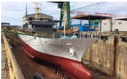
新潟造船工場で建造中の薩摩青雲丸697トン
