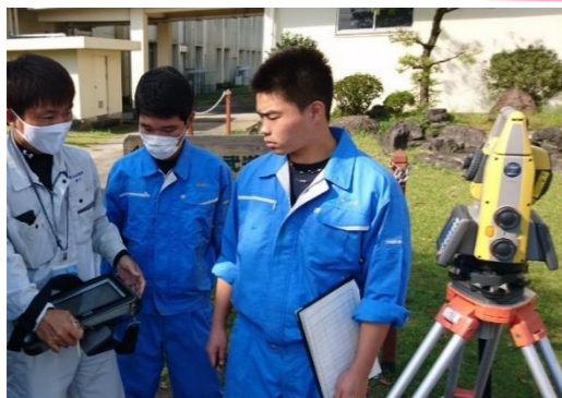
電子平板による平面測量
