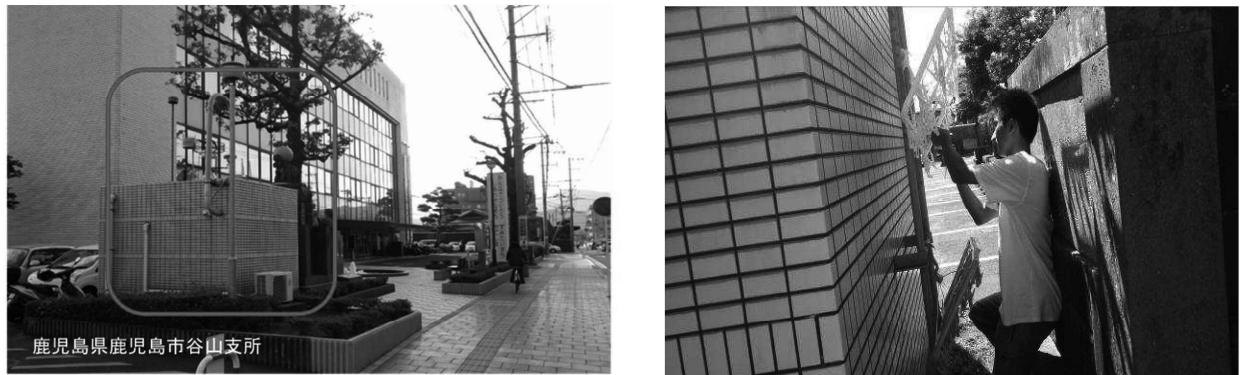
Fig.4 大気汚染物質広域監視システム（そらまめ君）の外観（左）と実際の測定の様子（右）
