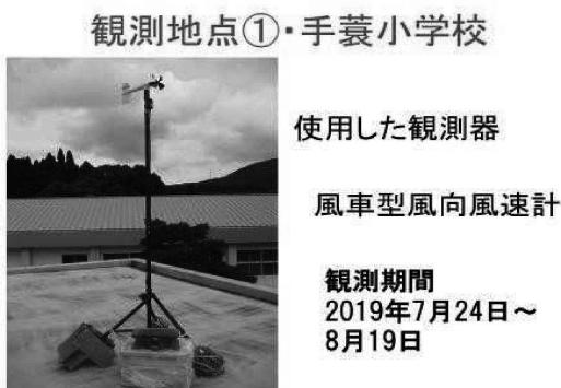
図4 風車型風向風速計
