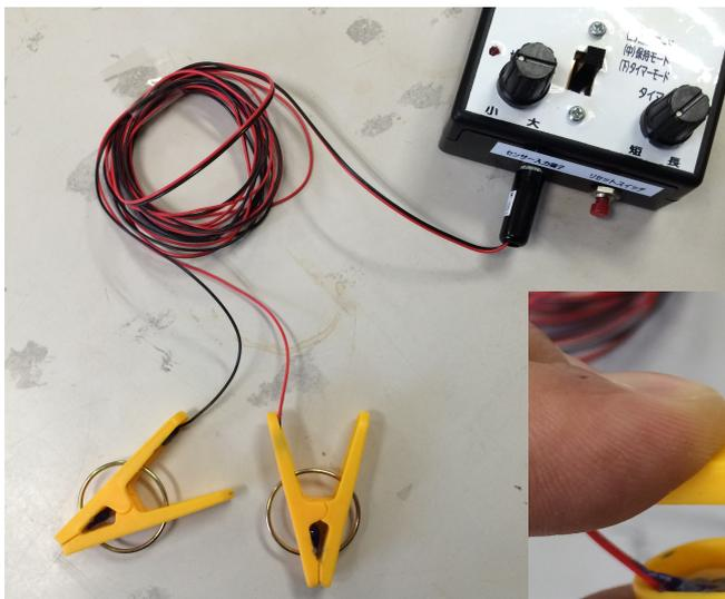
「センサーコード」をアルミ箔シールにハンダ付けし、片方のピンチ部に貼付
