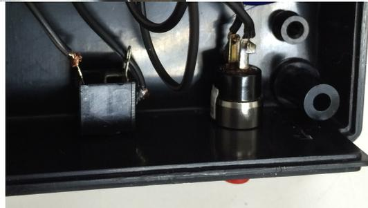
17 「炭素皮膜可変抵抗」それぞれに「つまみ」を取り付ける。「DC ジャック」に「かしこい AC アダプタ」を接続し、本体は完成。
