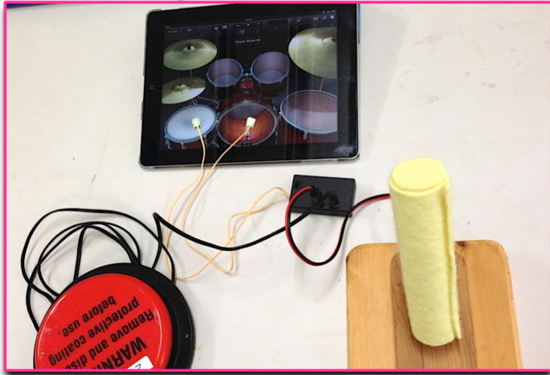
本体に好きなスイッチを取り付け、画面上のタップしたい場所にパーツを貼り付ければ、スイッチを使ってタップ操作を行うことができます。
