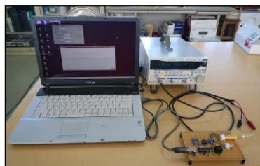
図 3 基盤・PC・発振器の接続
