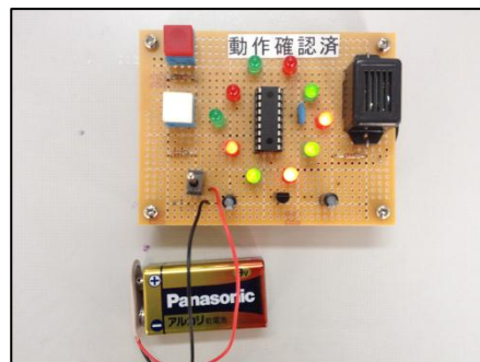
図1 研修で製作した電子ルーレット
