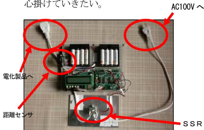
写真1 100V 電源制御回路
