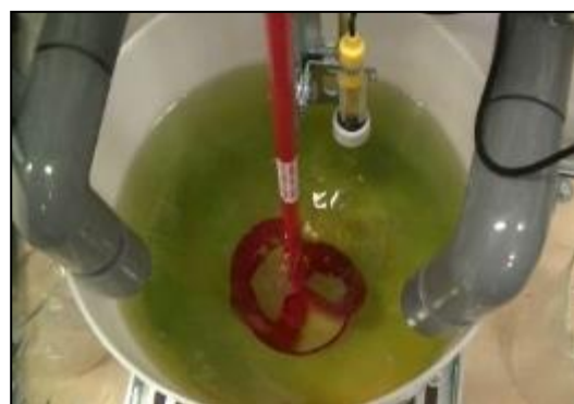
写真3 アルカリを滴下し、中和を行っている状態
