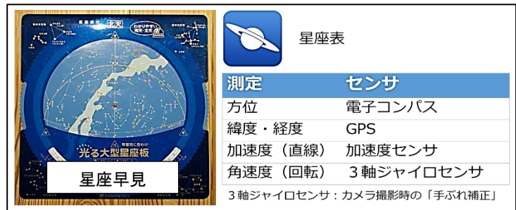
図36 星座早見と星空観測アプリに使用されているセンサ
